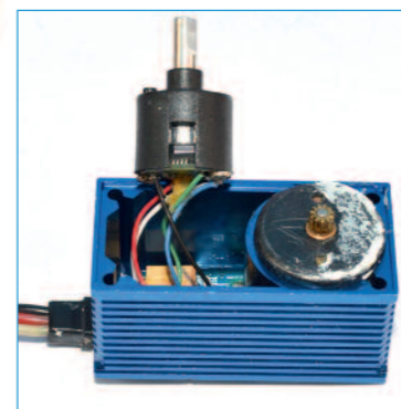
Anstelle verschleißbehafteter Potis zur Rückmeldung der Servopositionen werden in den Mahoney-Servos (außer 400CV) kontaktlose Hall-Sensoren verbaut.
