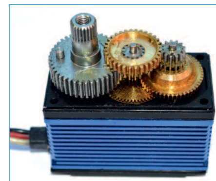
Die gut gefetteten Stahlzahnräder des Ganzmetallgetriebes sind zur Erhöhung der Standzeit und Verminderung der Reibung mit Titan beschichtet.
